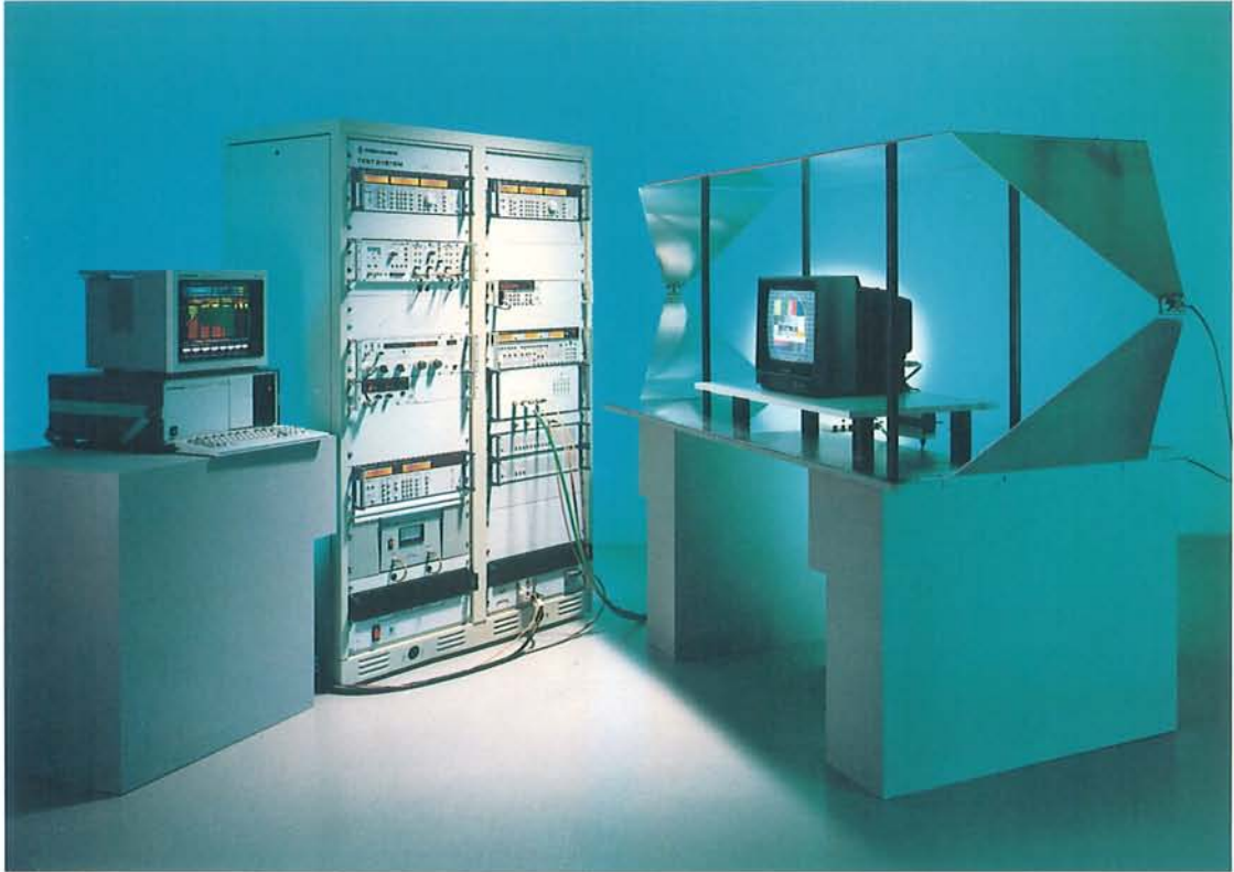
Ein typisches Einsatzgebiet für HF-Millivoltmeter: Kontrolle der Feldstärke im Inneren einer Streifenleitung bei der Störbeeinflussungsmessung
